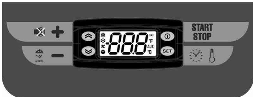
All'avvio il controllore effettua un lamp-test di 5 secondi dopo di che si pone in "Operativo".
